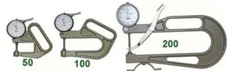
Tipo professionale, con CONTATTI A RULLI, larghezza mm 8,7 e diametro mm 8,4. Apertura utile mm 5. Profondità arco mm 50. Particolarmente adatti per misurare spessori di cavi, fili, nastri, ecc. Divisione 1/100 mm, con levetta sensitiva e ritorno automatico. Grande quadrante di facile lettura con 2 lancette indicanti: millimetri, i decimi e centesimi di millimetro.
