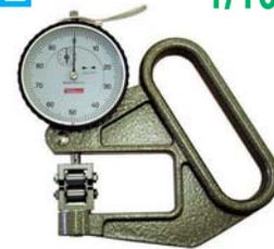
Divisione 1/100 mm, con levetta sensitiva e ritorno automatico. Particolarmente adatti per misurare spessori di pastiglie punterie di motori. Tipo con base d'appoggio e contatti a forma piana (inf.) e sferica (sup.).
